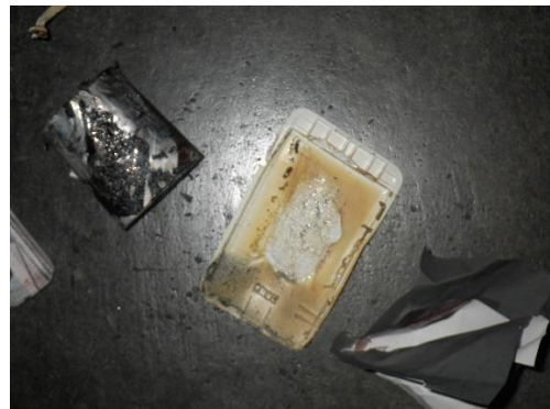
写真6 モバイルバッテリーの焼損状況
